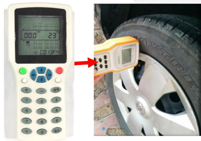
**手持校订仪器**，主要是通过发射一定功率，一定时序的低频（125kHz）信号将传感器激活，激活后能接收传感器的ID和当前轮胎温度和压力的数值，并按照设定的要求实现轮胎位置绑定学习、轮胎换位及传感器的更换学习工作。主要用于整车装配、车轮对调位置和传感器更换对系统的学习。
